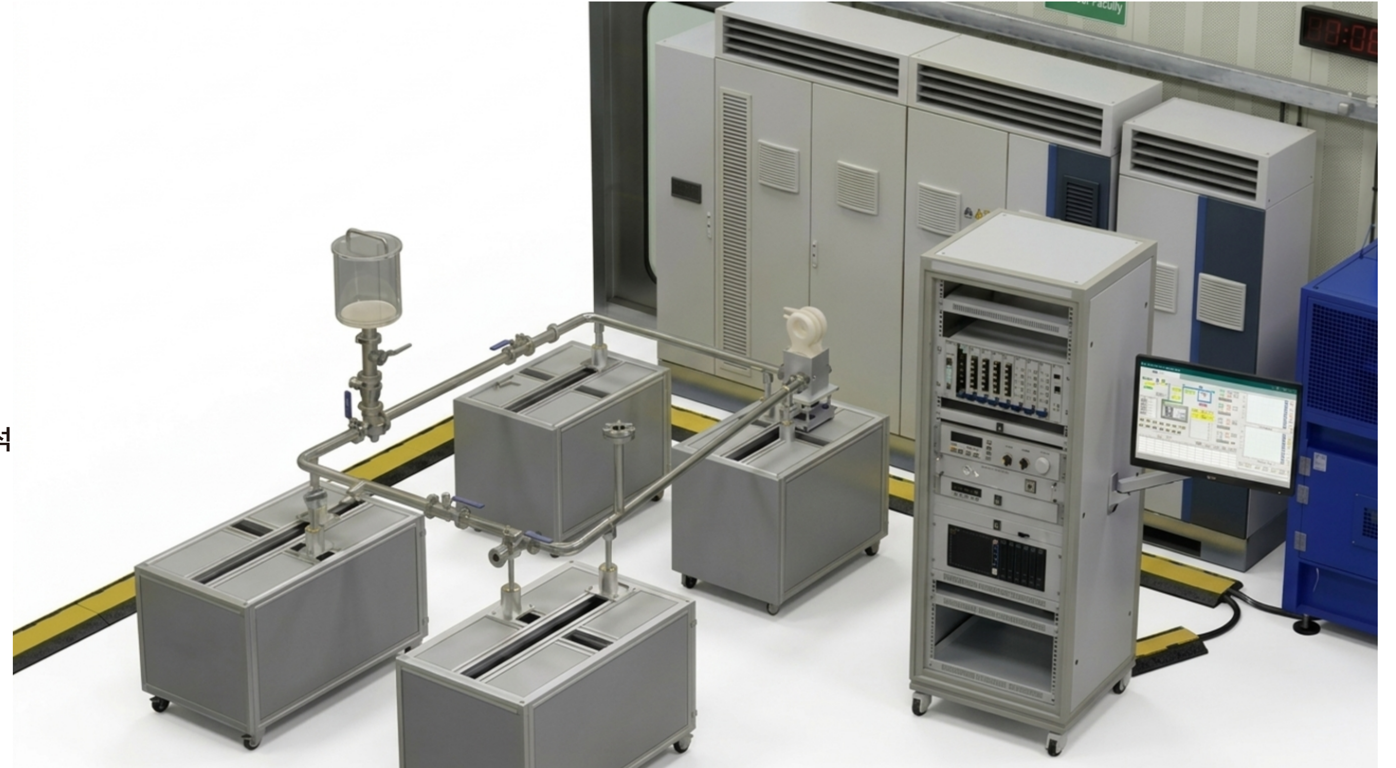
(주요 제품) 수소 재순환 송풍기 성능 시험 설비 : 수소차 내 수소 공급을 위한 컴프레서 블로어 테스트
